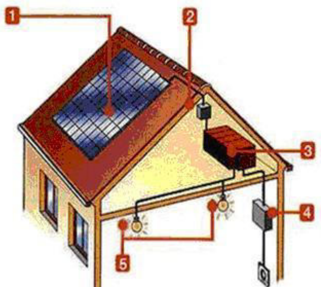
Figura 3.1 – Instalação típica e suas identificações
